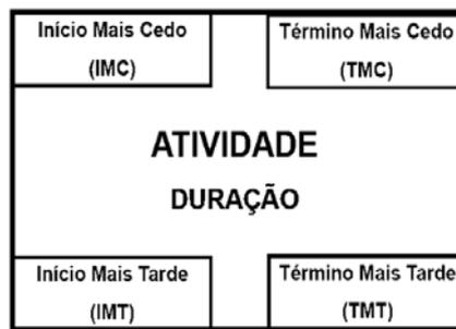
**Figura 2. Descrição do que cada componente da caixa (Fonte: Autoria própria).**
