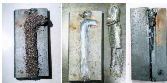
Figura 7. Soldagem na chapa a 400 A (com escória; sem escória; fundo da peça)
