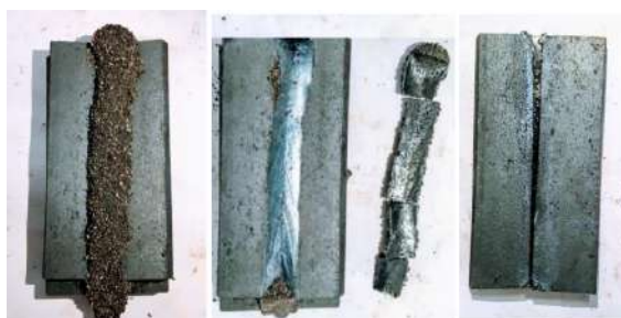
Figura 6. Soldagem na chapa a 300 A (com escória; sem escória; fundo da peça)
