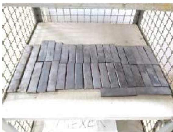
Figura 4. Chapas de 6 mm para realizar a soldagem
